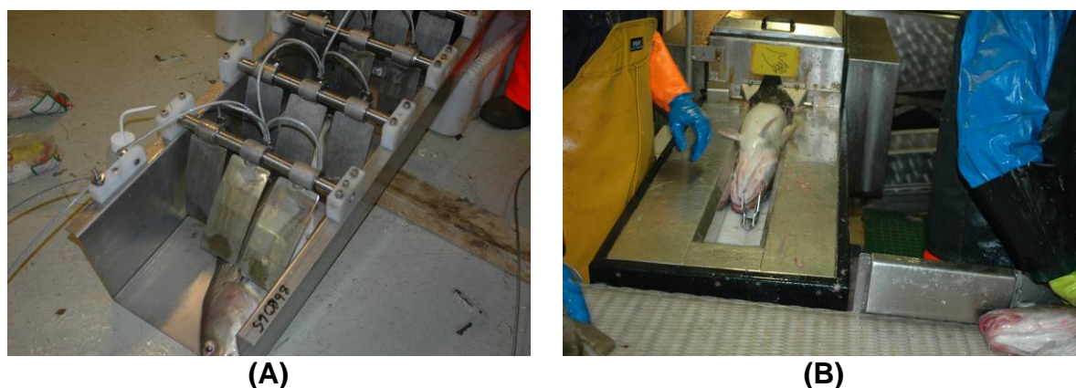
Fig. 18 - (A) Elektrobødøving av torsk før sløyning med testutstyr fra SEASIDE AS;
