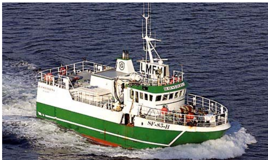
Fig. 2 - Det kombinerte line- og garnfartøyet M/S "Havstjerna". Lengde 21,0 m, bredde 6,4 m og dybde 5,4 m.
