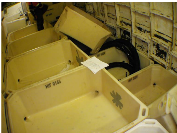
Fig. 25 - Temperaturloggere tapet fast på innsiden av fiskekarene.
