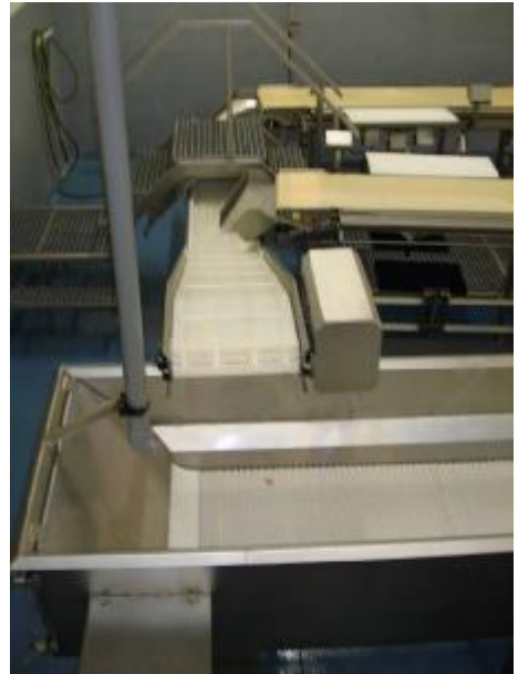
Figur 3. Overføring av filet fra trimmebord til filetkjøler. Enden av det doble trimmebåndet er synlig i bakgrunnen, innmatingsdelen av filetkjøleren (issørpekaret) i forgrunnen.
