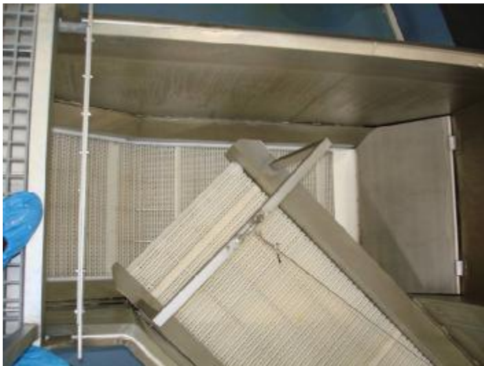
Figur 6. Overgang mellom andre og tredje transportbånd i filetkjøler. Filetene føres ut av tanken v.h.a. av båndet i bunn av tanken, og mates ut mot venstre side av figuren.
