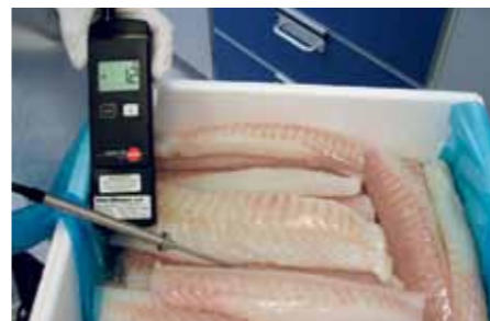
Måling av kjernetemperatur i superkjølte torskeloins
