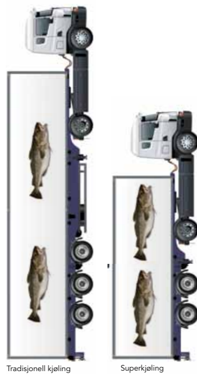
Med superkjøling reduseres fraktmengden 30-50% fordi fisken ikke ligger i is, men er sitt eget kjølemedie.
