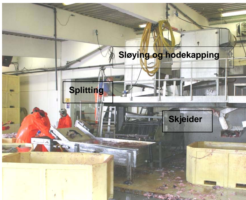
Bilde 3 Produksjon av ryggsei. Først sløyning og hodekapping, så splitting, deretter i skjeider og videre i vann/bulkløfter, før den saltes i kar.
