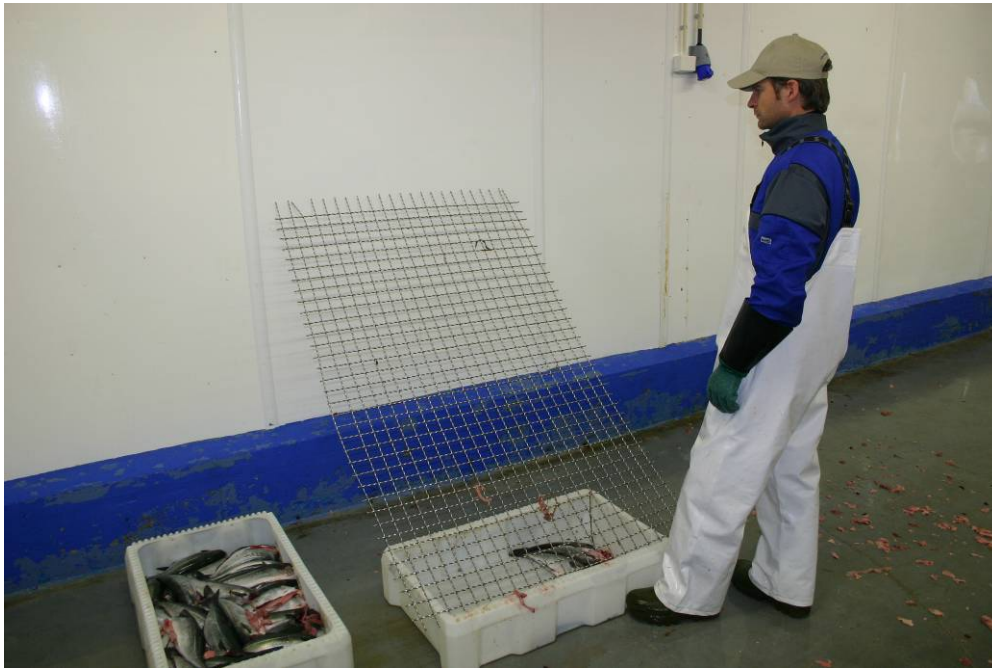
Bilde 21 Test med netting for å fjerne slog og lever.
