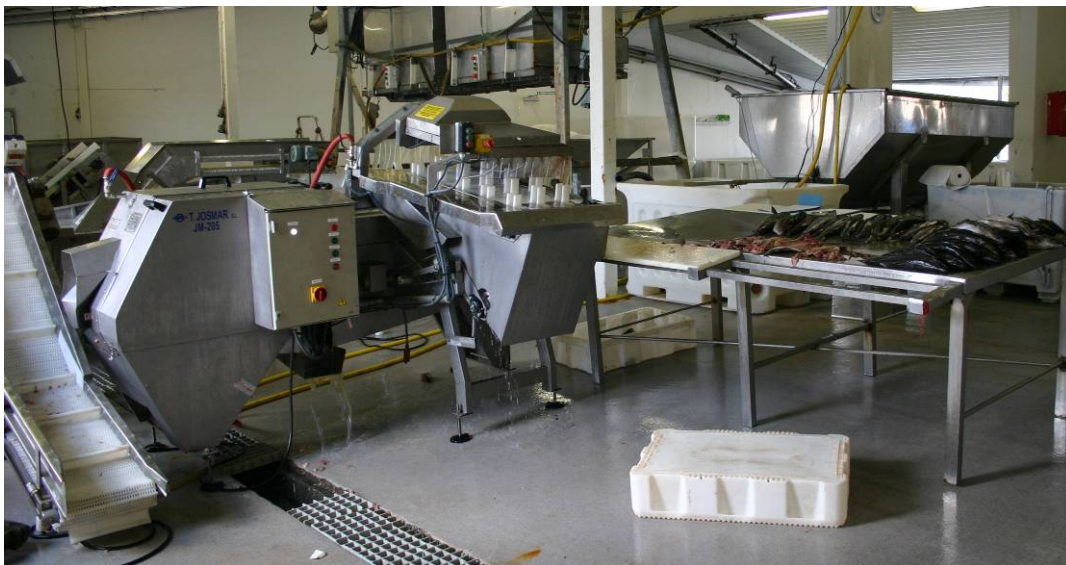
Bilde 25 Josmar 205 maskinen testet på ryggseiproduksjon. Hodekappedel til høyre og sløyemaskin til venstre.
