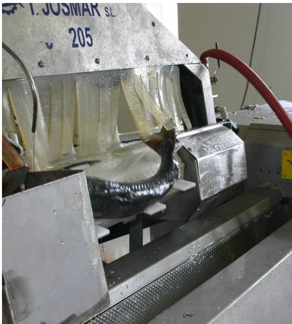
Bilde 27 Fisk ut av hodekappedel (venstre) og i renne for innmating til sløyedel.
