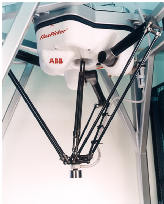
Fig. 5.16 Eksempel på robot (Flex Picker av fabrikat ABB) med mulighet for raske bevegelser av verktøy med begrenset vekt. Denne typen roboter benyttes bl.a. til å plukke sjokoladebiter i fart liggende på transportbånd og plassere bitene i korrekt posisjon i en konfektetse. Denne robot-typen kan være et alternativ også for kveisfjerning.
