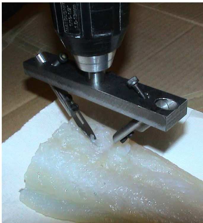
Fig. 5.9 Vertikalt roterende verktøy med skråstilt skalpell under testingen i laboratoriet.
