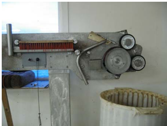
Figur 7. Bøtestasjon for lagring av klargjort line i stamp
