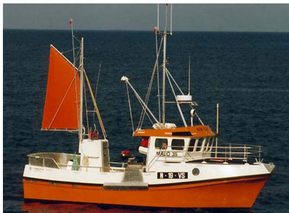
Figur 3.3: Kystfiskefartøy på 35 fot i komposittmateriale fra Norpower (til venstre). Norpower arbeider nå med et tilsvarende fartøy på 38 fot. Bildet til høyre viser en Proff Speedsjark på 38 fot i kompositt fra Selfa Arctic. Dette fartøyet har en toppfart på 24 knop.
