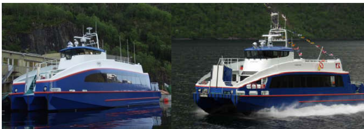
Figur 3.9 Rygerkatt (til venstre) og Rygerfjord til høyre). Katamaran passasjerfartøyer i karbonfiber-sandwich produsert ved vakuuminjisering. Rygerfjord er 21 m lang og kan ta 97 passasjerer. Med 2 x 500 kW kan fartøyet operere med en hastighet på 30 knop og et drivstofforbruk på 7,5 liter/nautisk mil.
