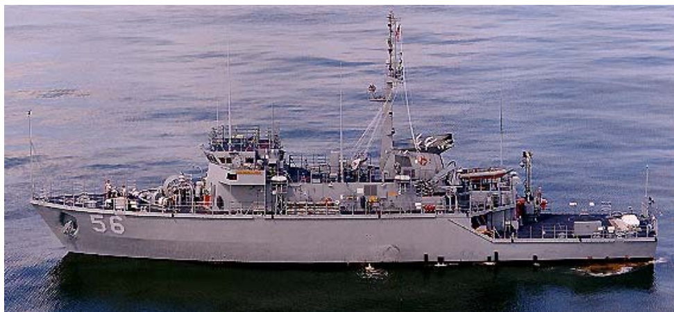
Figur 3.7: Minesveiper i Ospreyklassen bygd i komposittmaterialer (enkeltskall)
