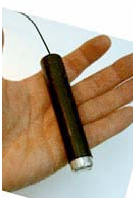
Bilde 5 Eksempler på radiosendere. Enheten til venstre er en rimelig enkel radiosender som er vanntett og som gir 6 måneder driftstid før batteribytte. Enheten til høyre er inne kapslet i et flyteelement og sender også ut en digital ID.
