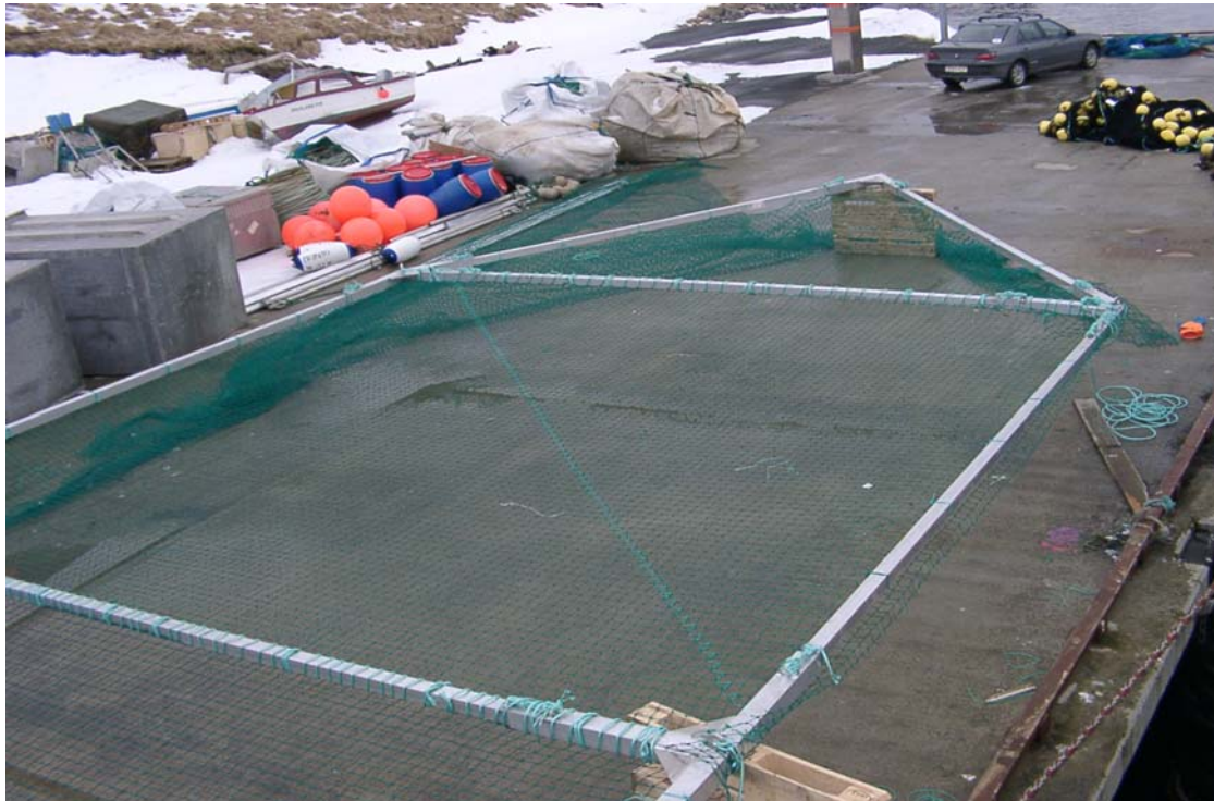
Bilde 5. Tilpassing og påsyng av flat og stram bunn for feltmerden.
