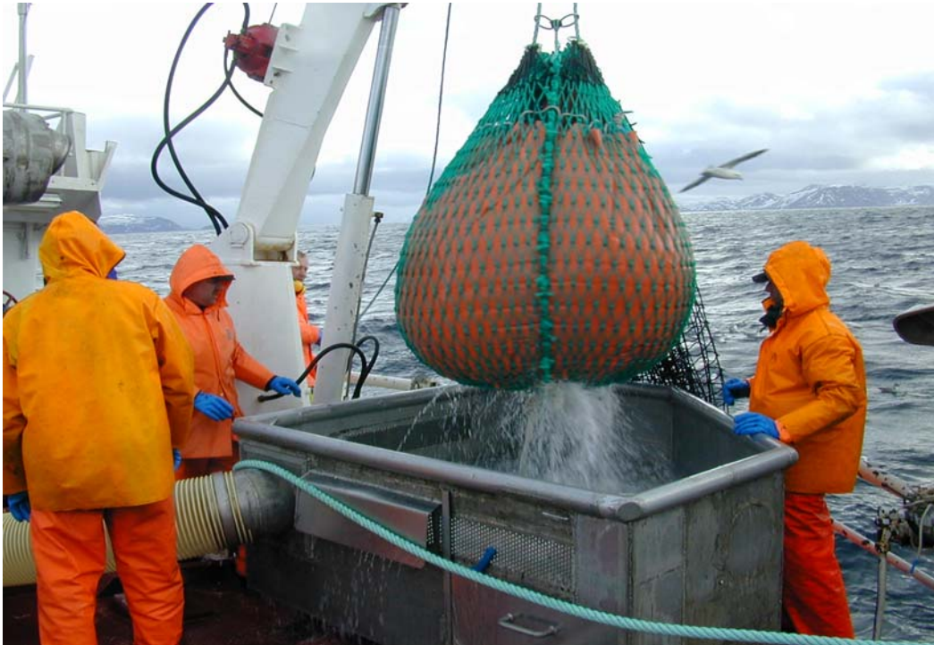
Bilde 2. Snurrevadpose med innmontert lerretsløft for skånsom ombordtaking av levende torsk i "vannbad". Fisken slippes ned i sorteringskar med lave karmar.
