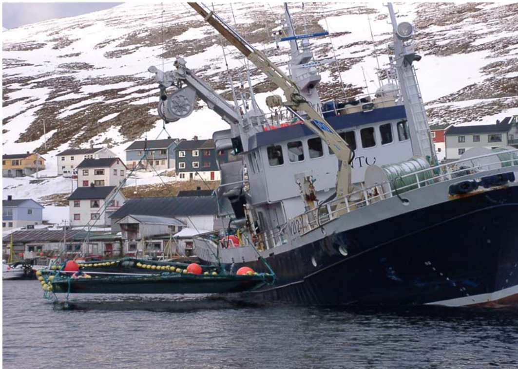
Bilde 3. Flatbunn med påmontert feltmerd løftes av kaia og "sjøsettes" av M/S "Trinto".
