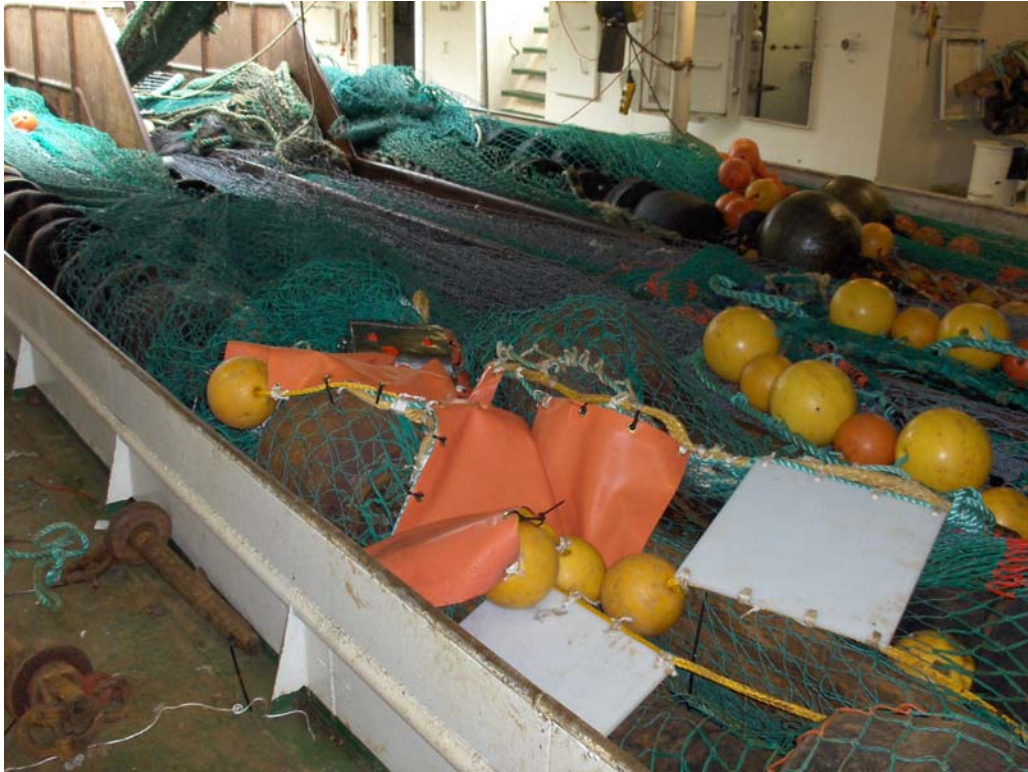
Figur 7. Seks løfteplater (1,5 m 2 ) montert på Alfredo 5-trålen. Øverste (fremste) tau med kuler er 35 cm kortere enn ordinær kuletelne på hver side.
