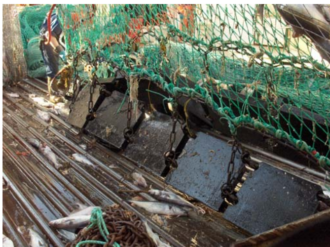
Figur 5. Nytt plategear sammensatt med lås mellom plater.
