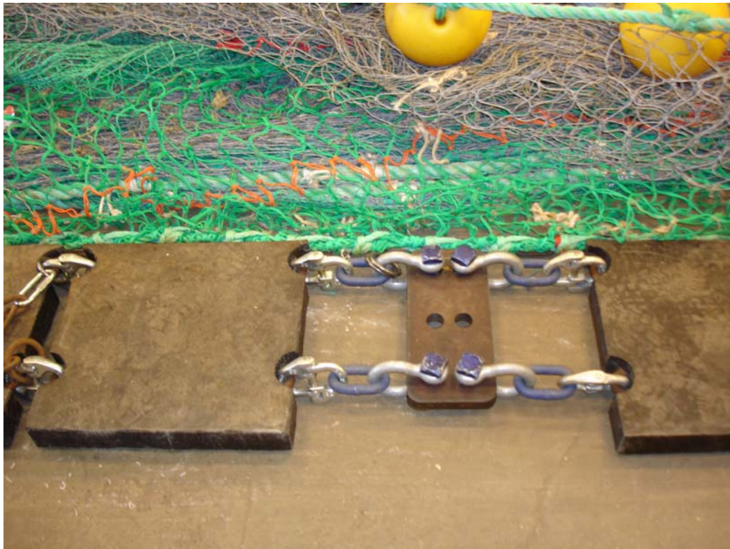
Figur 4. 50 x 50 cm gummiplater med innstøpte kjettinger.
