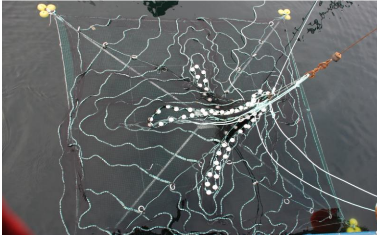
Figur 14. Rammebunn for feltmerd har nettopp foldet seg ut og er klar for å bli rigget med opphalingsvinsjer og fortøyningstau.
