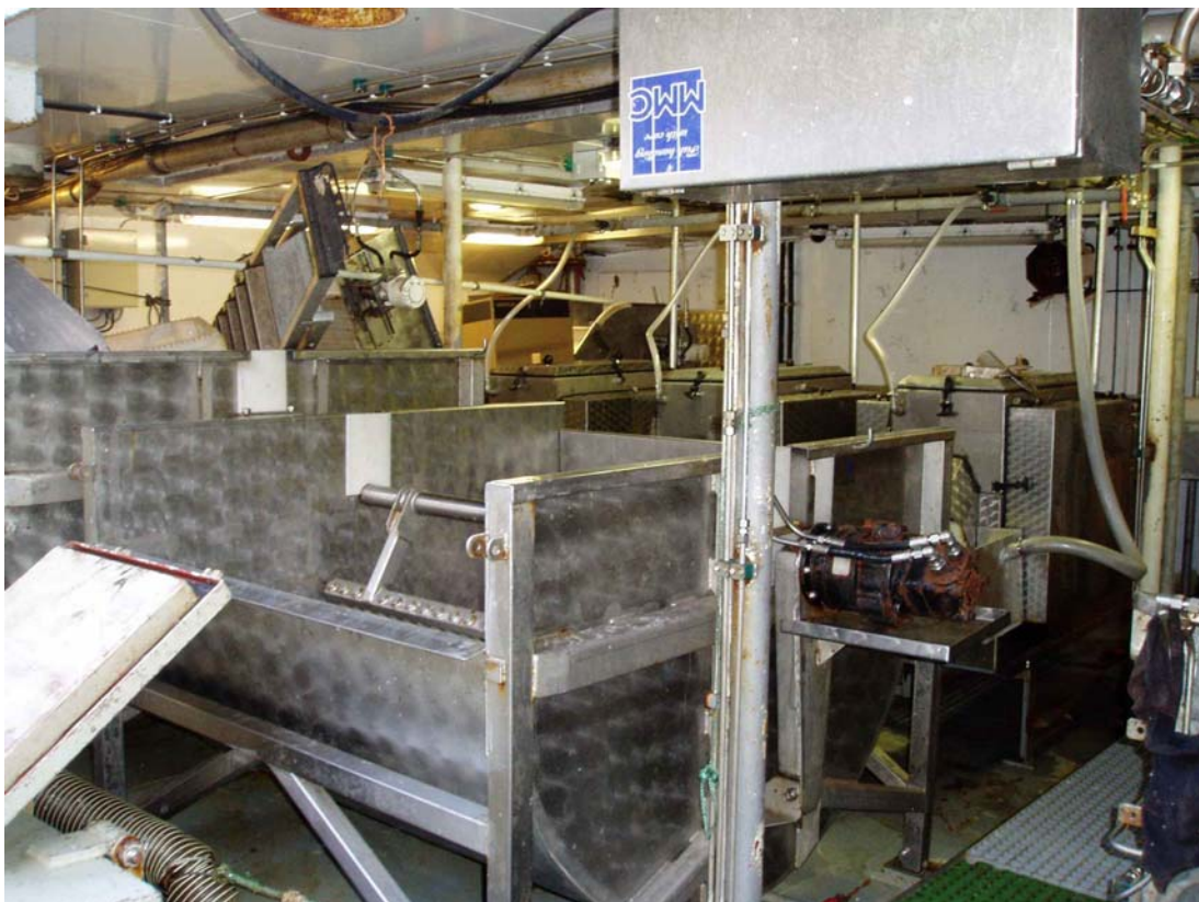
Bilde 6 Utstyr for fangstbehandling på hoveddekk ved fiske med snurrevad på 90 fots fartøy
