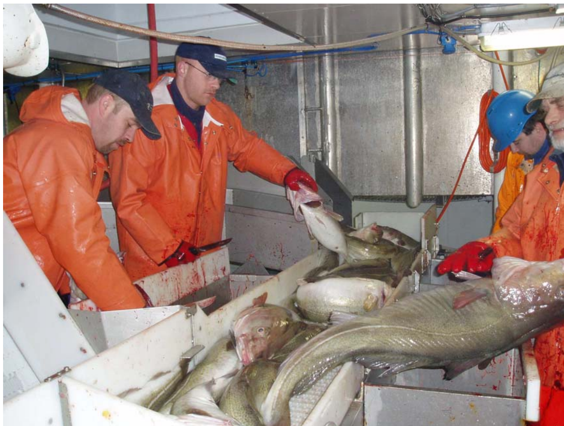
Bilde 17 Fisken direktesløytes av fire mann etter uttak fra buffertank (tørrtank)
