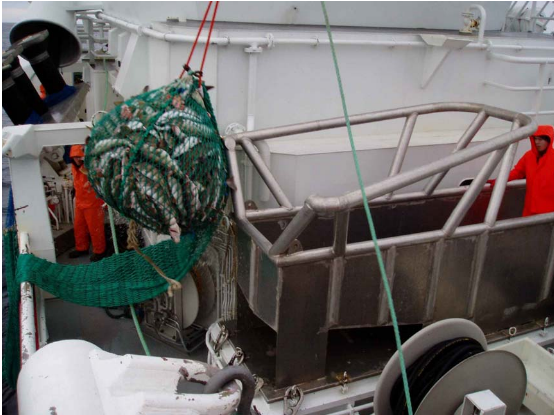
Bilde 13 Inntak av fangsten foregår ved sekking av 500 – 800 kg fisk pr gang
