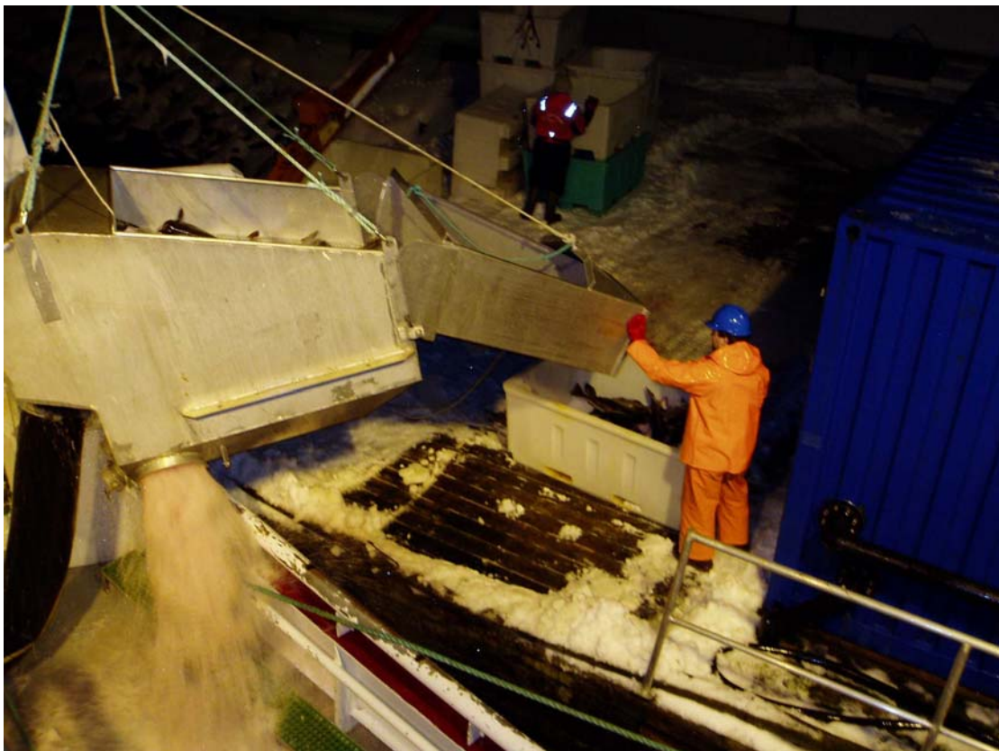
Bilde 26 Fisken pumpes fra RSW-tankene og over til containere på kaien
