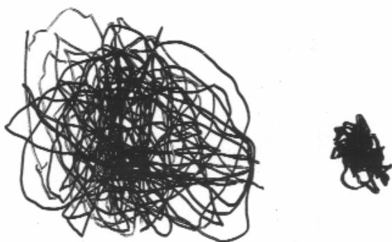
Til venstre: Standardposens svingninger set forfra aftegnet på en videomonitor over 5 minutter. Til højre: Samme aftegninger for posen med 90° vendt net.
