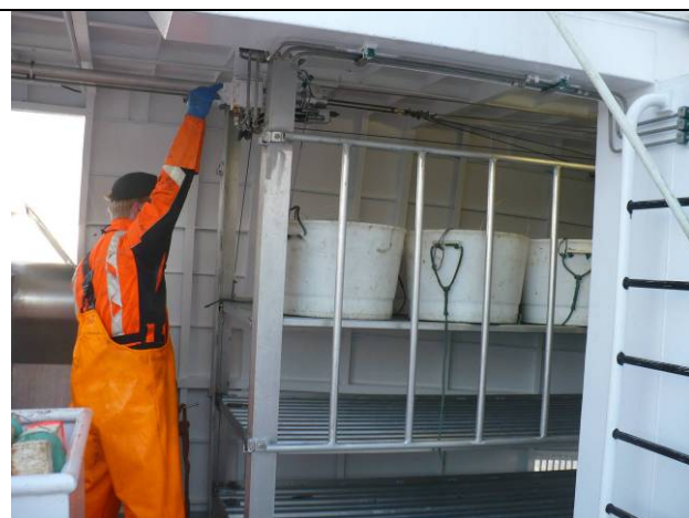
Hydraulisk senking av egnte linestamper
