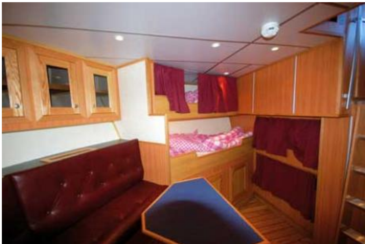
Bilde 6 Felleslugar med fire køyplasser plassert i baugparti sammen med dusj/toalett
