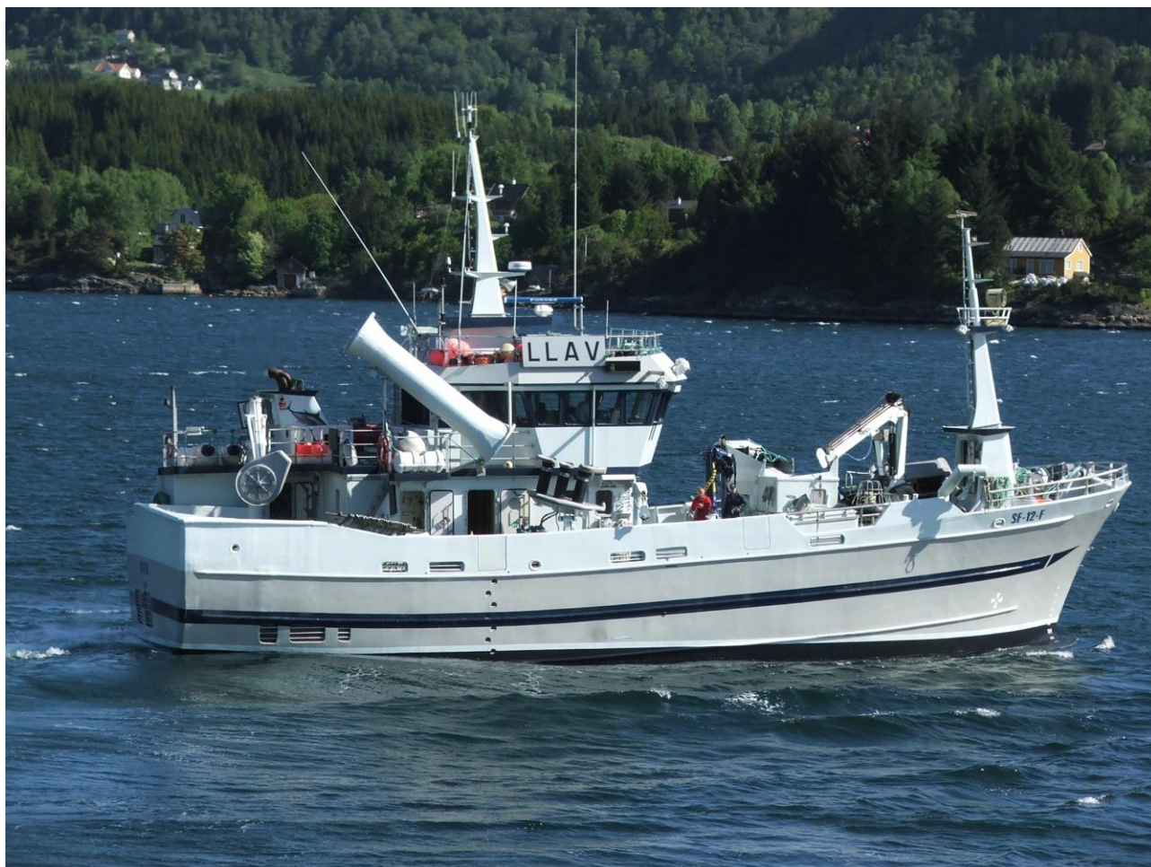
Figur 1: Bluefin er et fiskefartøy bygget i kompositt-/sandwichmaterialer av Mundal Båt AS. Bildet visert fartøyet etter at det nylig er forlenget fra 70 fot til 90 fot.
