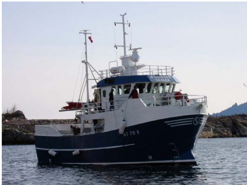
Bilde 4: Ny 49 fots kystbåt for fiske med not og garn, lasterom 60 m 3
