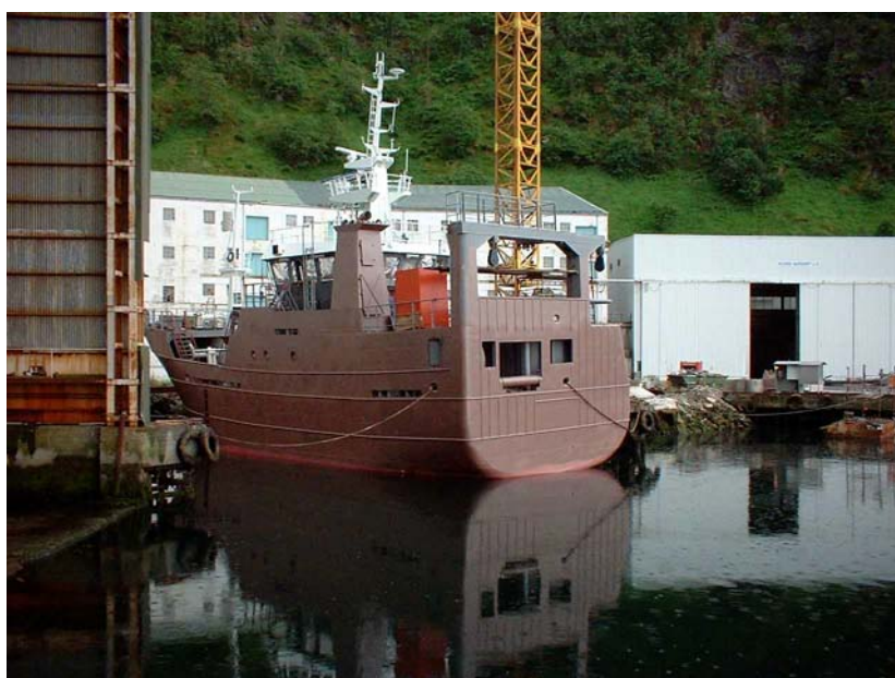
Bilde 9: En moderne en 90 fots kombinasjonsbåt under bygging år 2002
