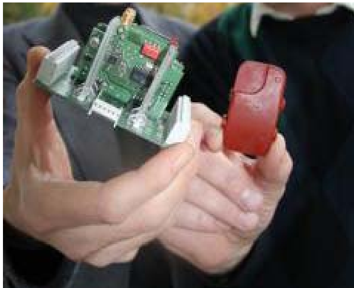
Bilde 10 Radiosenderen er til høyre. Mottakssentralen er til venstre. Foto Teknisk Ukeblad
