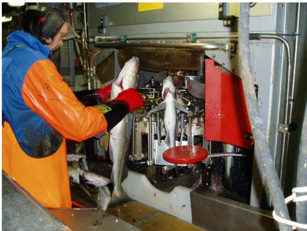
Bilde 15: Manuell mating av hodekapper, med nødstop
