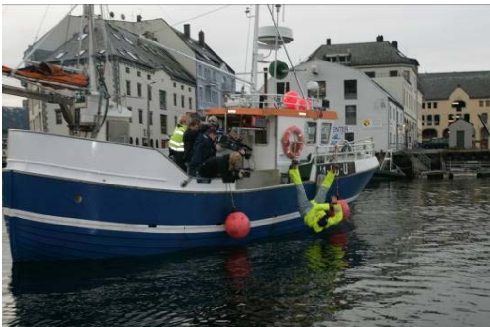
Bilde 1 Mann over bord under kontrollerte former iført arbeidsbekledning med flyteegenskaper (Regatta Fisherman).
