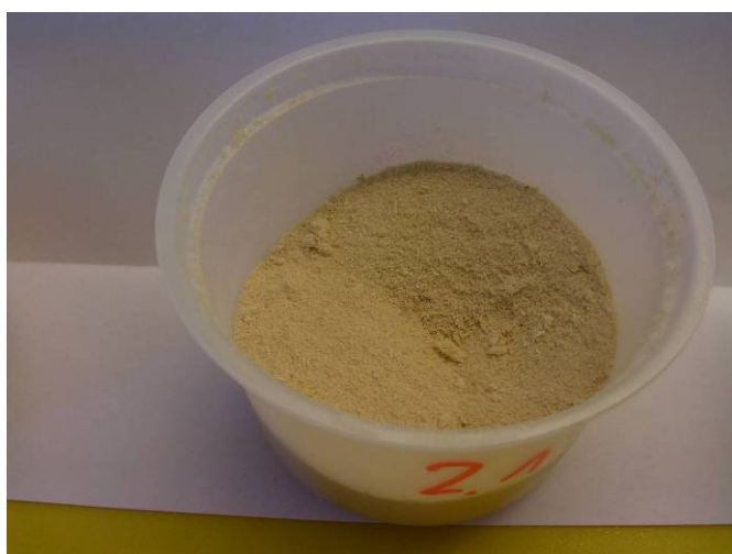
Figur 10. Tørket proteinekstrakt laget av samfengt krabbeskall.
