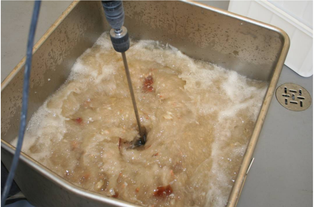
Figur 3. Vasking av krabbeskall med kraftig omrøring.
