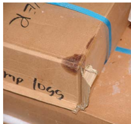
Bilde 15. Olje lekket ut fra lever og ut i emballasje.
