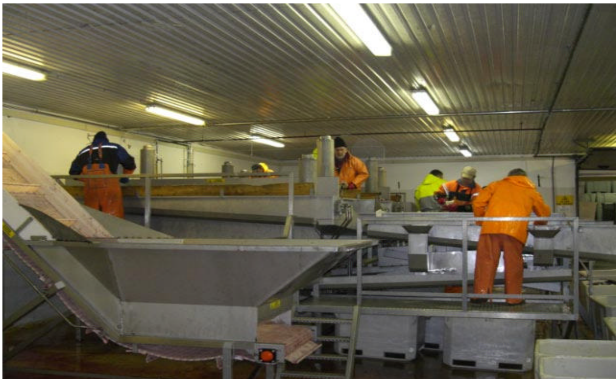
Inntaksbrønn på linjen. Kontainere tippes i brønnen
