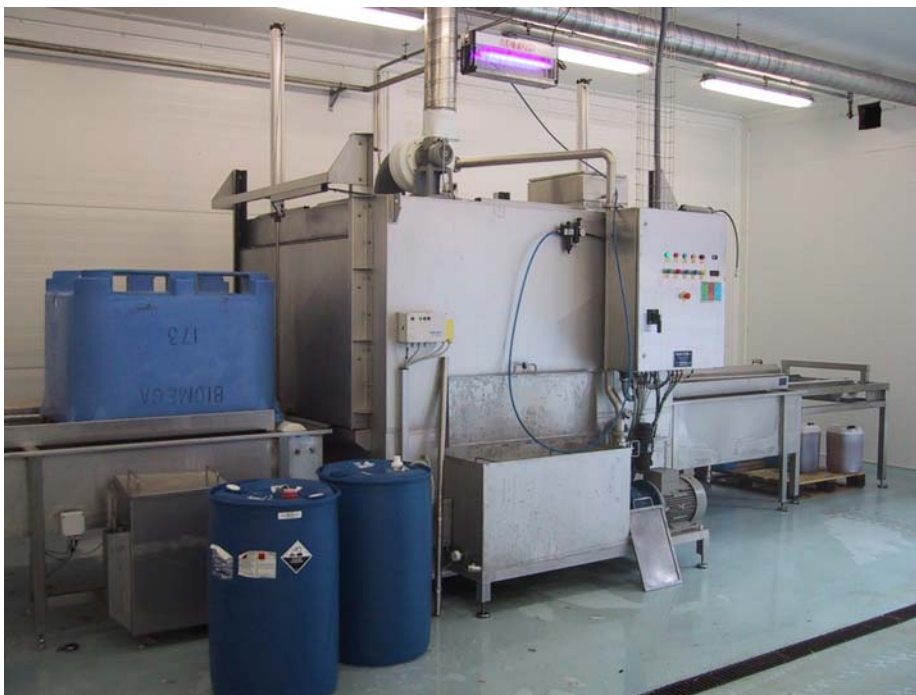
Figur 8. Automatisk vaskemaskin for transportkar ved Biomega.
