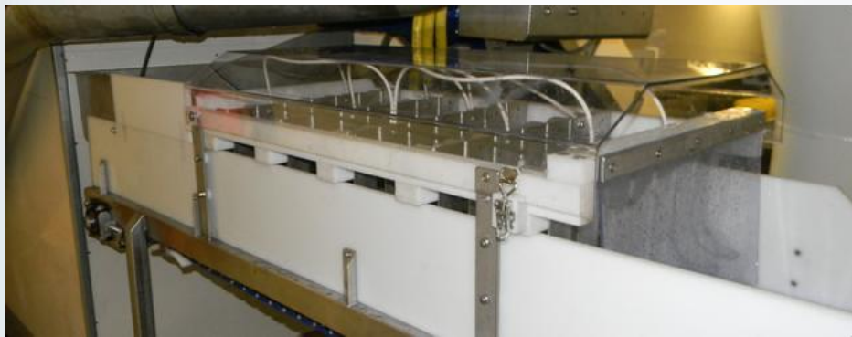
Bilde: SeaSide. Elektrobedøver montert ombord i fiskefartøy
